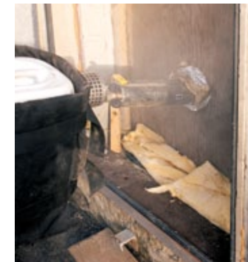
▲ De capaciteit van de Electrofog in combinatie met het middel Gro-Stop Electro is hoog en kan oplopen tot 1.500 ton aardappelen per uur.
