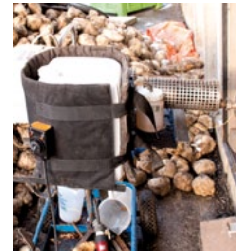
▲ Gro-Stop Electro is gevoelig voor uitvloeking. Vandaar het elektrische verwarmde 'jasje' om de jerrycan.
