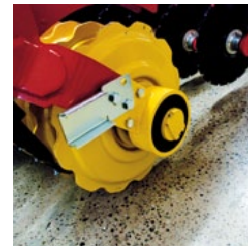
▲ Lagers van de rollen zitten in een rubberen behuizing. Daardoor geeft de rol minder trillingen door aan het frame.
