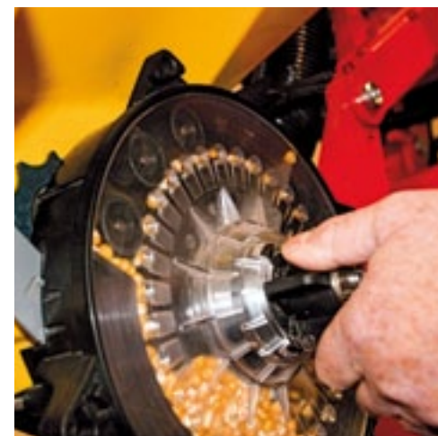
▲ De Tempo-precisiezaaimachine drukt met lucht het zaai-zaad tegen de zaaischijf en schiet het zaad vervolgens met 50 km/h in de grond.
