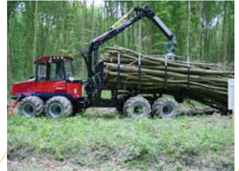
Lokale biomassa-extractie uit jong bos met behulp van een bosbouw-forwarder (foto: Borgman Beheer).
