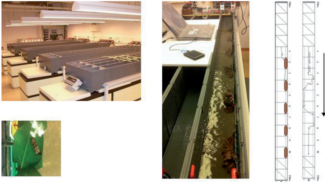
FIGUUR 15 HET KUNSTBEKEN LAB VAN ALTEERRA (A), MICROPTERNA SEQUAX OP EEN PAKKETJE VAN KUNSTMATIG BLAD (B), EEN STROOMGOOT MET BLADPAKKETTEN (C), EEN SCHEMATISCHE WEERGAVE VAN DE SET UP VAN HET EXPERIMENT MET EEN HOMOGENE BODEM (D) EN MET BLADPAKKETTEN AAN DE ZIJKANT (E)
