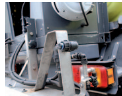
Kantsproeiers zorgen aan weerszijden voor een werking tot 2 meter buiten de sproeiboom.
