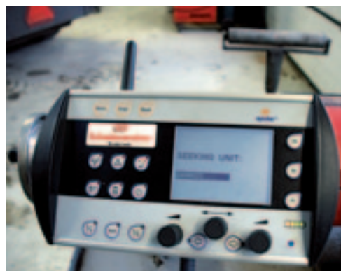
De geavanceerde versie van de terminal. Op deze Epomaster zijn drie knoppen afgeschermd.
