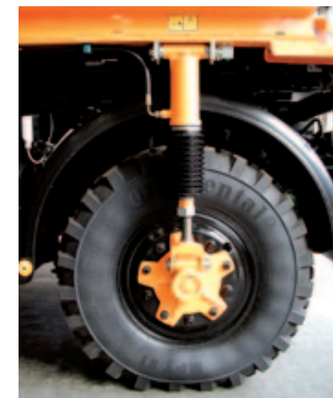
Bij het gebruik van een hydraulische arm op de laadvloer beveelt Unimog de hydraulische stabilisator aan die inveren tegengaat.
