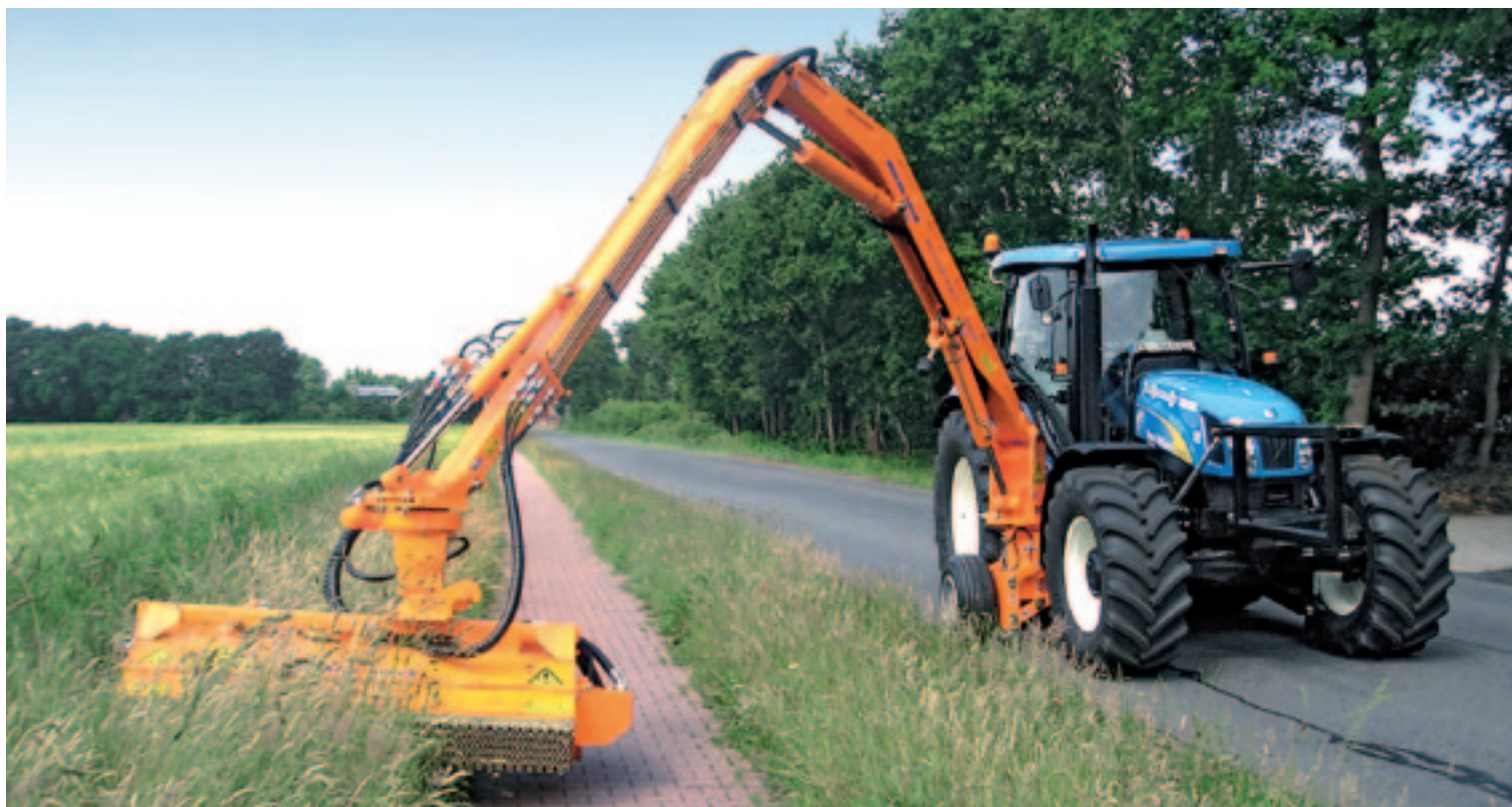
Een bekend beeld langs Nederlandse wegen en watergangen: onderhoud met een hydraulische arm aan de zijkant van de trekker. In dit geval is het geen product uit Middelburg, maar uit het Zuid-Duitse Oppenau, bij Baden-Baden. De arm heeft de aanduiding GZA: dat staat bij Mulag voor Gerät ZwischenAchs.
