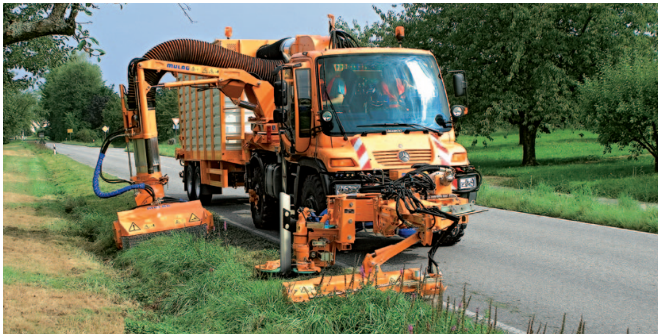
Bij het gebruik van een hydraulische arm op de laadvloer beveelt Unimog de hydraulische stabilisator aan die inveren tegengaat.
