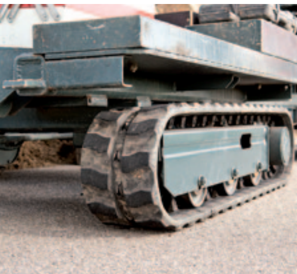
De 4 ton wegende machine staat op vier rupsen. Daardoor kan hij ook op kwetsbare fietspaden uit de voeten.
