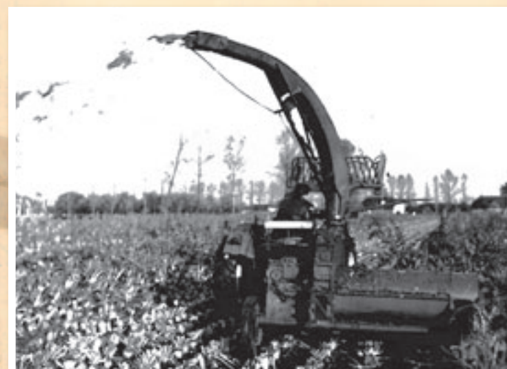
Bij het rooien van voederbieten wordt het loof soms met een getrokken veldhakselaar verwijderd en weggespoten.
