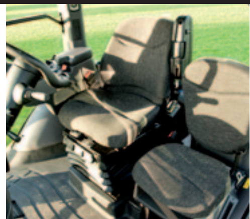
▲ De zeer ruime stuurhut van de Challenger MT700-trekkers. Er is een comfortabele bijrijdersstoel en ruimte genoeg voor koelboxen.
