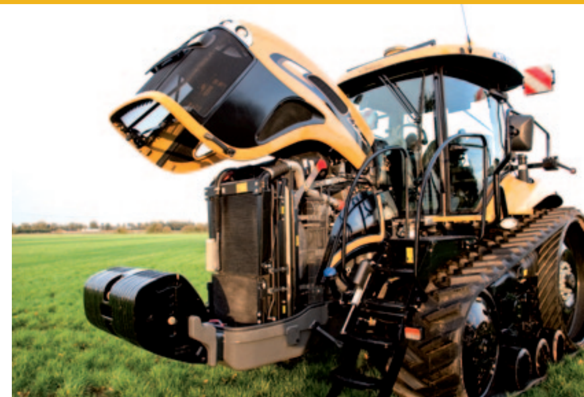
▲ Het hart van de nieuwe MT700D-serie is deze Sisu-zescilinder. Voorheen was de trekker nog voorzien van een Caterpillar motor, maar Agco verwisselde die voor een krachtbron uit eigen huis.
