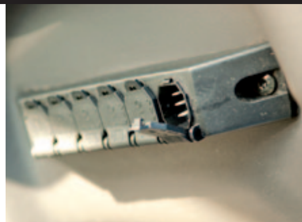
▲ In de cabine zijn er voldoende elektrische aansluitingen. Helaas zijn ze van het Amerikaanse soort. Er is dus altijd een verloopstekker nodig.
