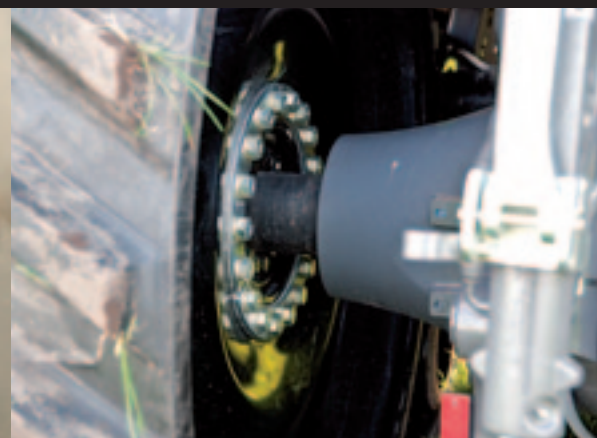
▲ De trompetten van de achteras zijn vergroot. Dat moet de as meer stabiliteit geven.
