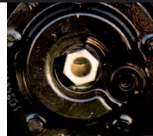
▲ Alle lagers van de kunststofrollen die de rups geleiden, zijn voorzien van kijkglasjes. Zo is te zien of ze voldoende smering hebben.
