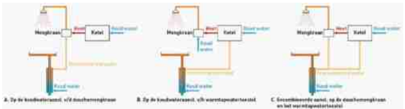
Figuur 13: Mogelijkheden voor het aansluiten van douchewarmteterugwinning (Ten Have, 2006).
