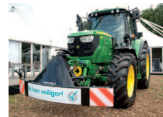
▲ Op initiatief van Cumela waren een aantal trekkers op de ATH uitgerust met een bumper.
