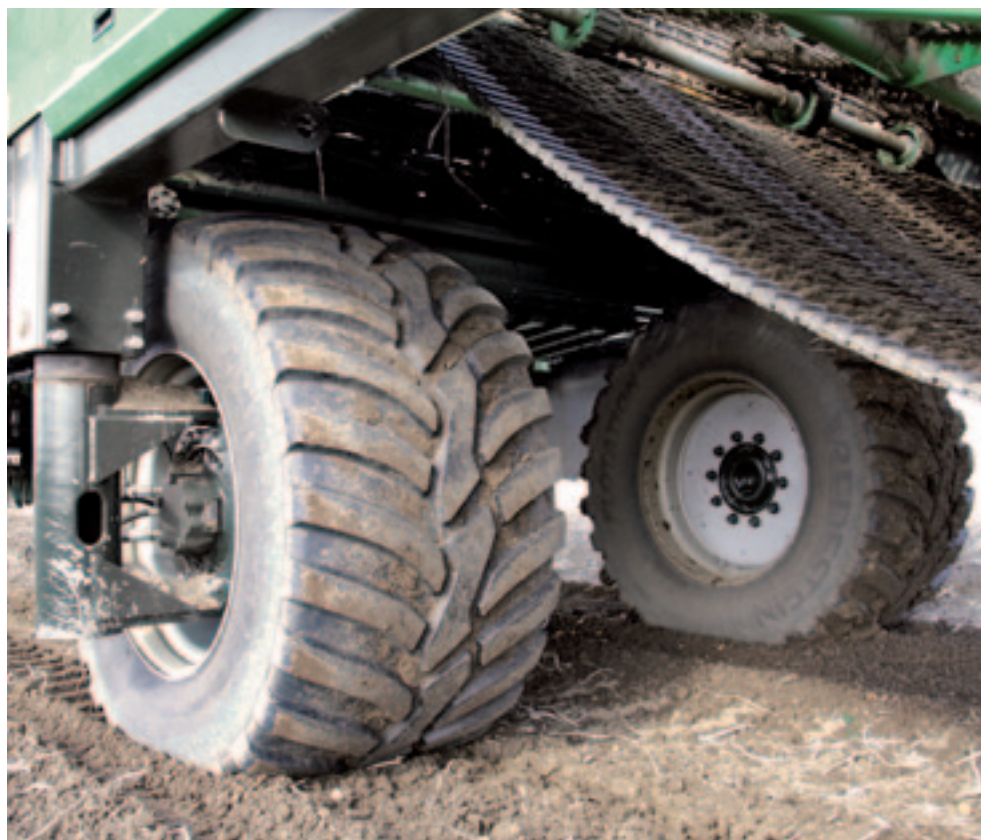
▲ De machine is voorzien van portaalassen. Daardoor kunnen loof en grond zich niet onder de machine ophopen.
