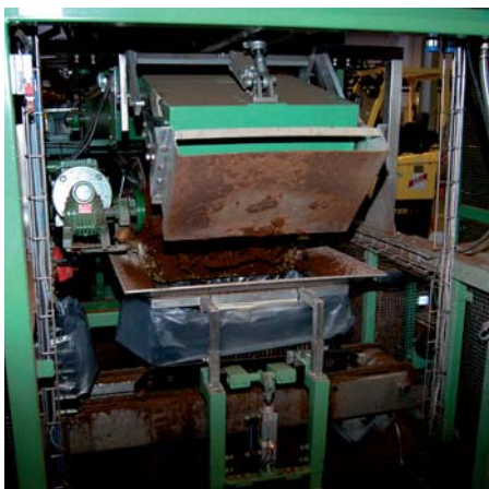
De zelf ontworpen gronddoseerunit in één van de inpaklijnen
