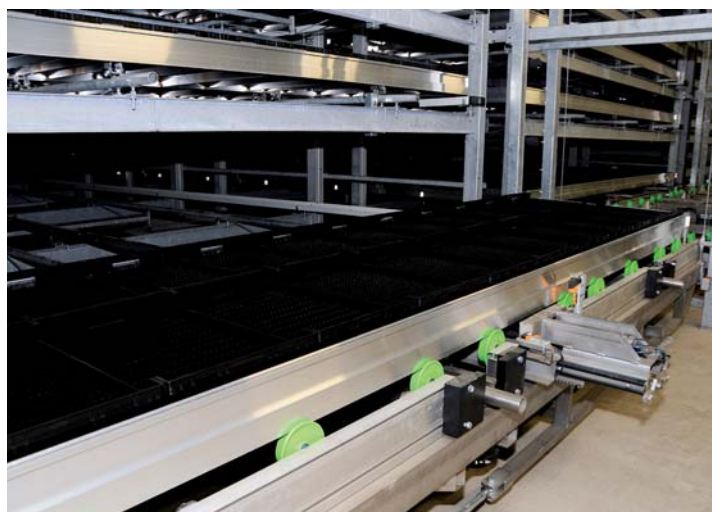
Een impressie van de liftinstallatie die de container naar een ander niveau tilt
