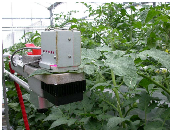
Figuur 3-1 De bladkamer van de fotosynthesemeter voor het meten van fotosynthese en verdamping aan tomaat.
