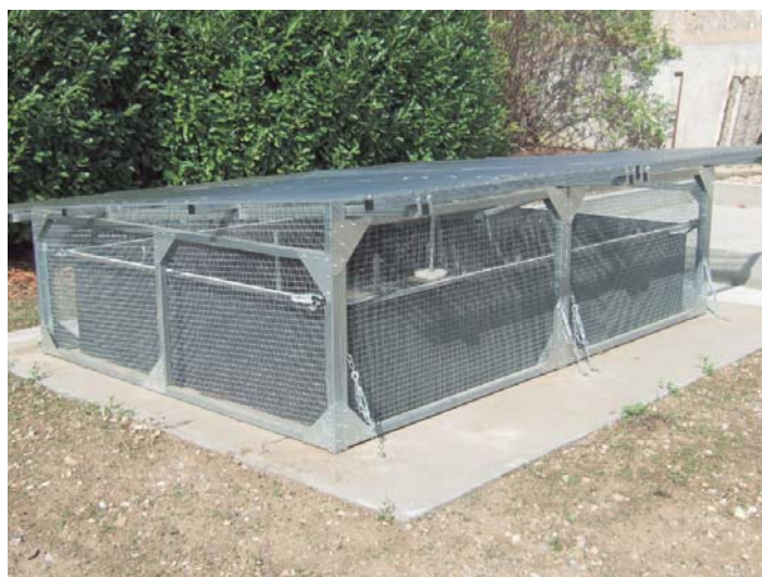
De Heliosec is een grote kunststof opvangbak met een zeil aan de binnenkant, waar 2500 liter restwater in kan. Het afvalwater verdampst en het residu blijft achter.
