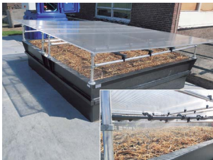
Bij de PhytoBac komt het afvalwater met resten van gewasbeschermingsmiddelen druppelsgewijs in de bak. Bacteriën breken de actieve stoffen af.
