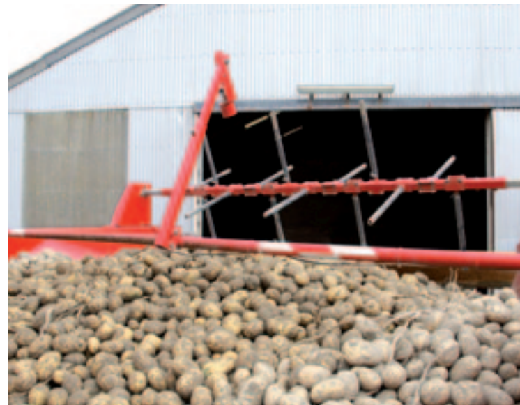
▲ In het midden is de ultrasonische Capacity-Control-sensor te zien. Deze regelt automatische de bodemsnelheid. De uienhaspel is een optie.
