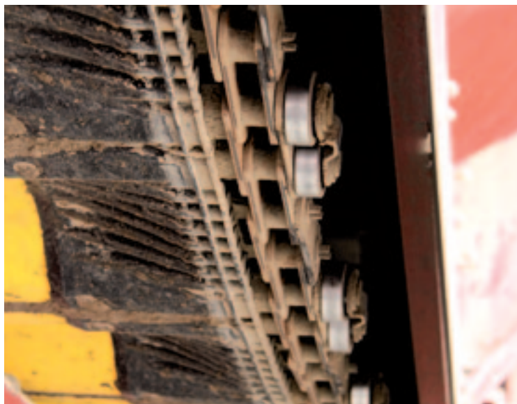
▲ De bodemketting is het enige onderdeel dat handmatig gesmeerd moet worden. De looprollen zijn op termijn een keer aan vervanging toe.
