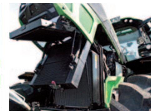
▲ De koelers klappen als een waaijer open en zijn zo goed toegankelijk voor reiniging.
