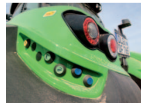
▲ De hef, aftakas en topstang zijn op het spatbord te bedienen. Ledverlichting is standaard.
