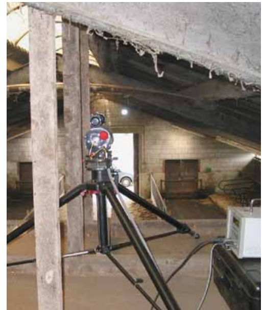
Foto 1 De laser wordt opgesteld onder de nok en gericht op een reflectorplaat boven de grote deur; de weerkaatste lichtbundel wordt door de verwerkingseenheid (rechtsonder op de foto) geanalyseerd en daaruit volgt de gasconcentratie van ammoniak of CO 2 .
