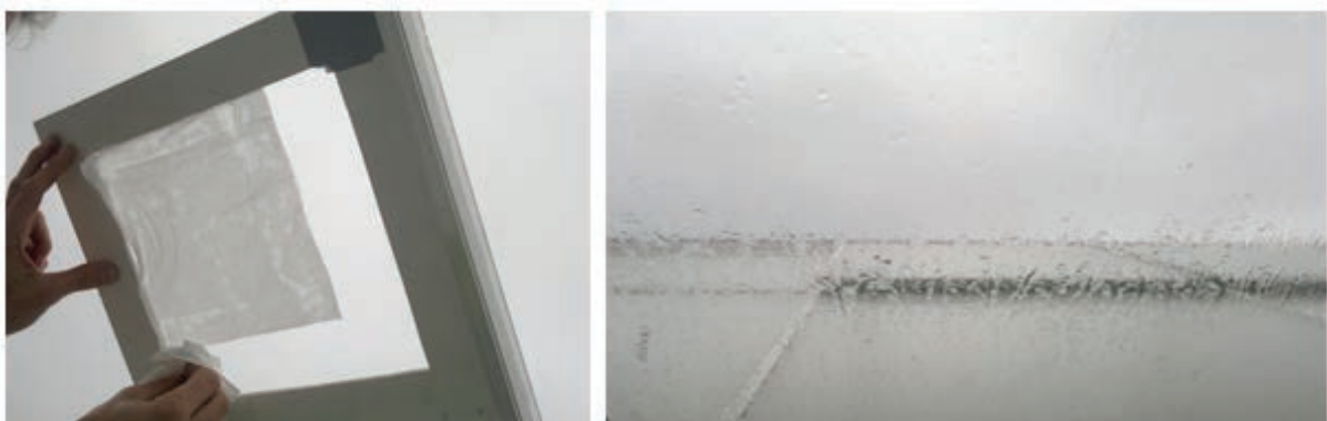
Figuur 1. Meting hoeveelheid condens met behulp van een sjabloon en papieren zakdoekjes.
