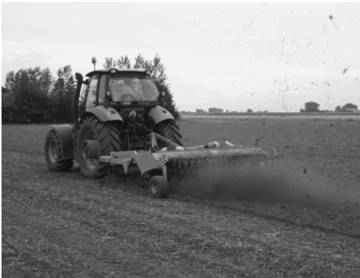
Figuur 3. Met KVIKUP frees worden grond en ondergrondse delen losgemaakt en opgeworpen en komen ondergrondse delen bovenop de grond terecht.
