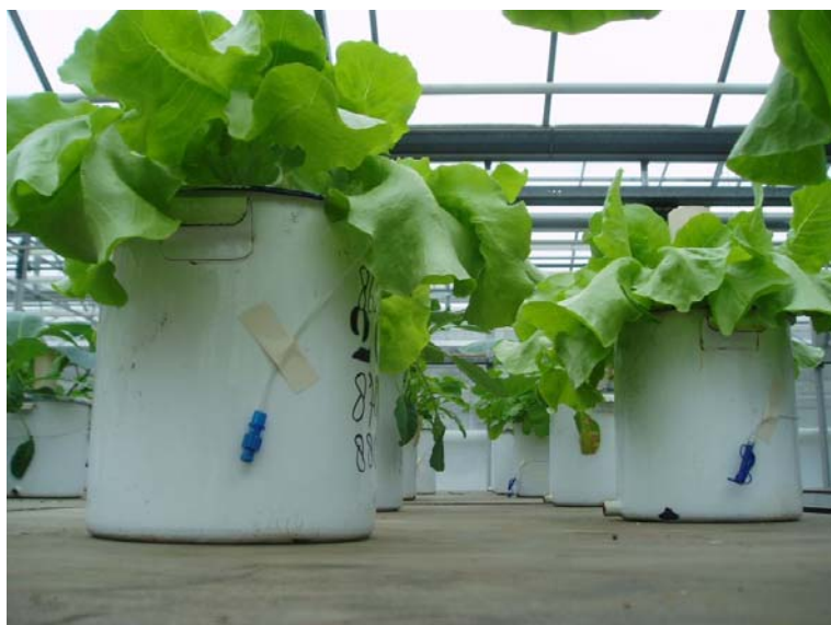
Foto 2. Overzicht van de sla potten en de aansluiting voor de bemonstering van het bodemvocht (blauwe knop)
