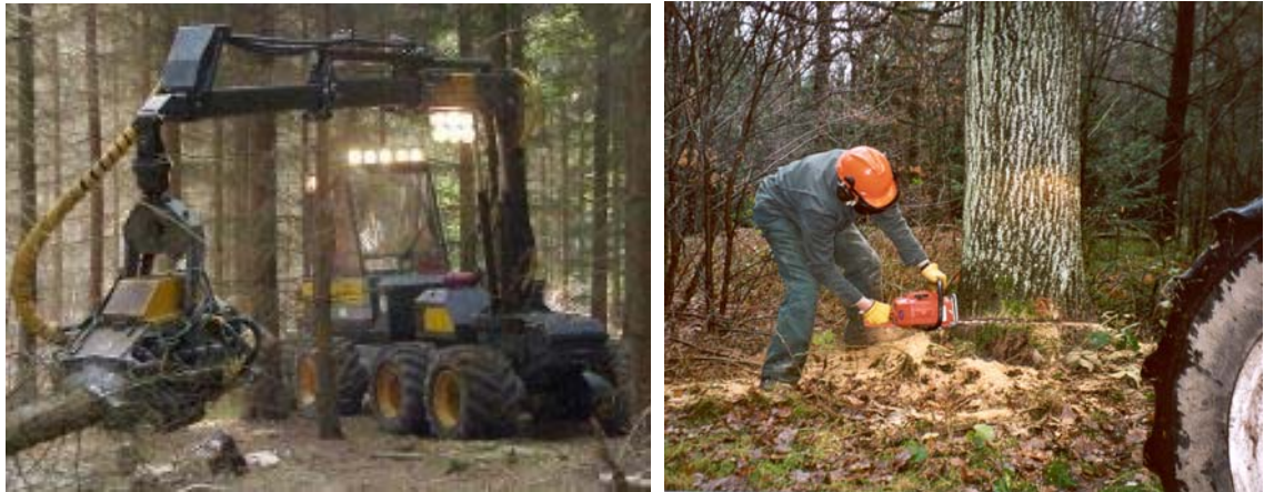
Figuur 2: Vellen met een Harvester (links) of met een motorkettingzaag (rechts)
