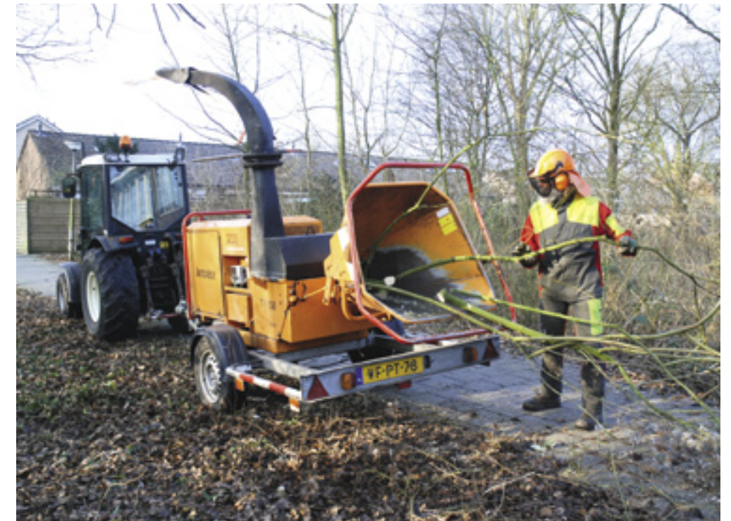
■ Een versnipperaar op een aanhangwagen heeft een reminrichting met een oploopprem. In deze uitvoering kan die achter een trekker maar ook achter een auto gekoppeld worden.
