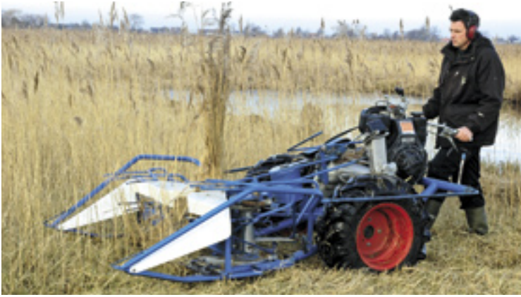
Uitmeermachine van BCS die met wat aanpassingen een behoorlijke capaciteit kunnen maaien, maar wel meer inspanning vergen dan een machine waar je op kunt zitten.
