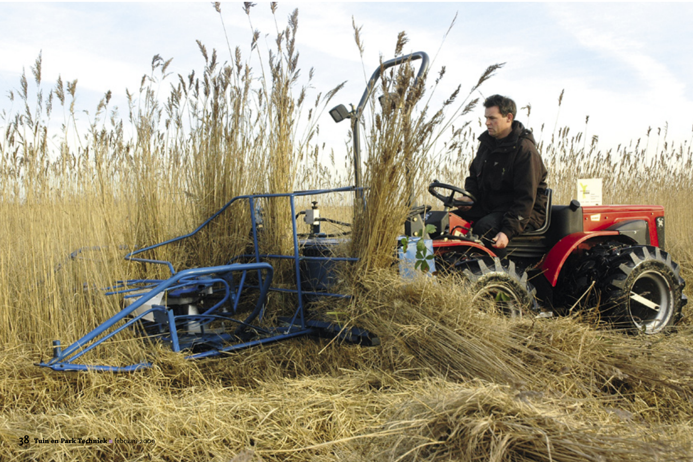
Met een aangepaste BCS maaier-binder aan een trekker met omkeerinrichting kan met een behoorlijke capaciteit worden gemaaid. Draagkracht blijft de beperkende factor. BCS maait met een enkele messenbalk. Scherpe messen en een correcte snijhoek zijn essentieel. In het midden worden de bossen met touw gebonden.
