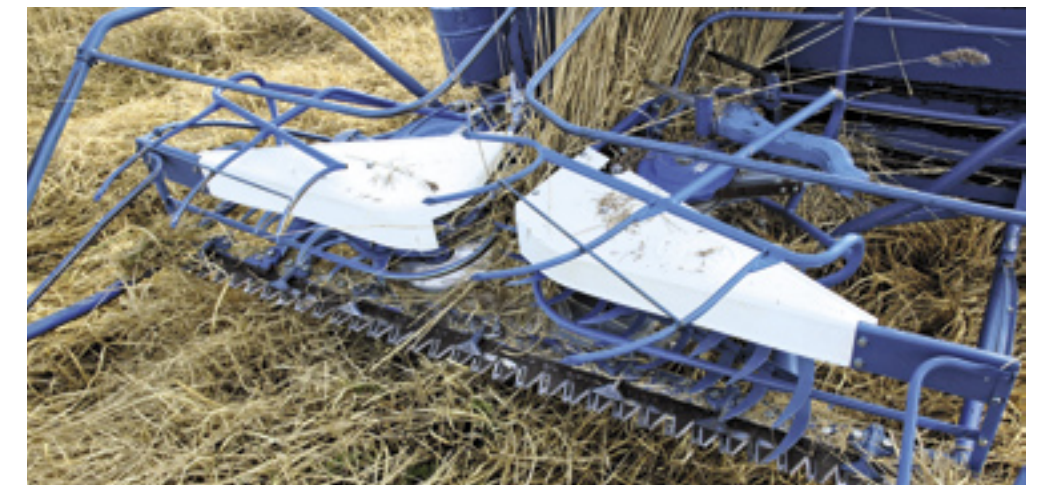
Met een aangepaste BCS maaier-binder aan een trekker met omkeerinrichting kan met een behoorlijke capaciteit worden gemaaid. Draagkracht blijft de beperkende factor. BCS maait met een enkele messenbalk. Scherpe messen en een correcte snijhoek zijn essentieel. In het midden worden de bossen met touw gebonden.
