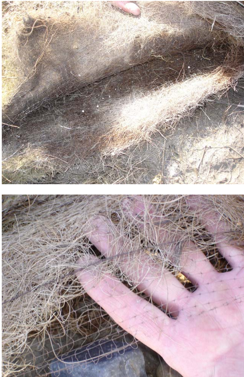
Figuur 4. Waargenomen kunststofdraden en kunststofgaas in de kokosfiltermatten
