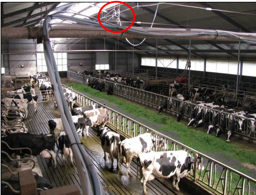
Twee cyclonen (PM10 en PM2,5) voor de bepaling van fijn stof in de luchtstrooming van de uitgaande lucht.
