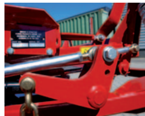
Met verstelbare stangen is het mogelijk het maaidek voorover of achterover af te stellen.
