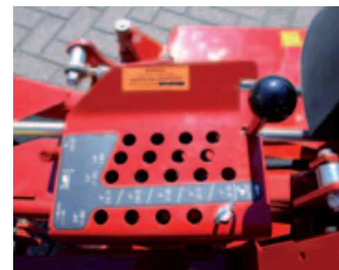
Door het verzetten van het stalen pinnetje is de maaihoogte te verstellen.
