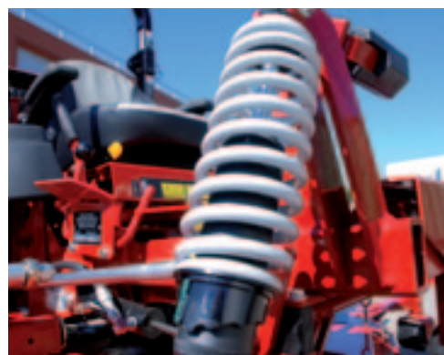
De vering van de bestuurdersconsole met schokdempers maakt de hoge maaisnelheid mogelijk.
