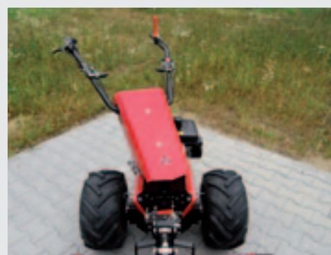
De stuurboom kan als optie 20 graden zwenken of in zijn geheel naar de andere kant. Ook hoogteverstelling hoort daar bij.
