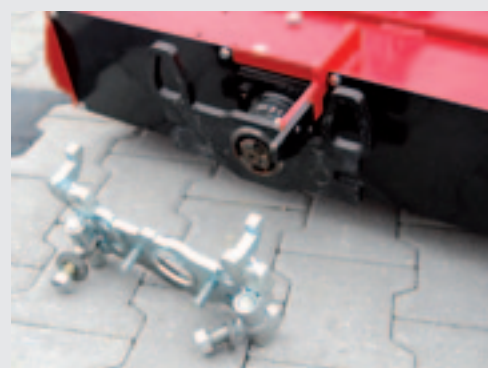
Deze adapter met vanghaken vergemakkelijkt (bij eenmanswerk) het aankoppelen van zwaardere werktuigen.
