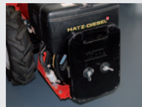
Bij sommige werktuigen wordt omwille van de balans een contragewicht aanbevolen. Ze zijn er van 10, 22 en 30 kg.
