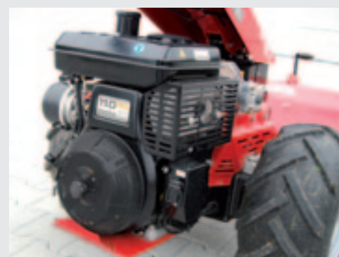
De Hydro Compakt Comfort is leverbaar met vier verschillende krachtbronnen, waaronder deze 11 pk benzinemotor van Robin.
