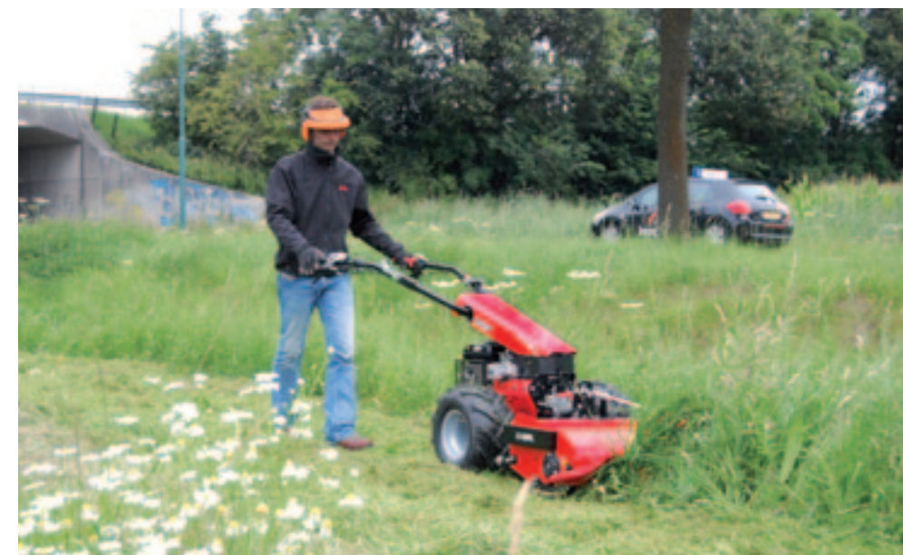
Het maaien of klepelen van bermen, slootkanten, taluds en hellingen blijft bij uitstek het meest geschikte werk voor een eenasser, omdat hij wendbaar is en bijzonder stabiel.
