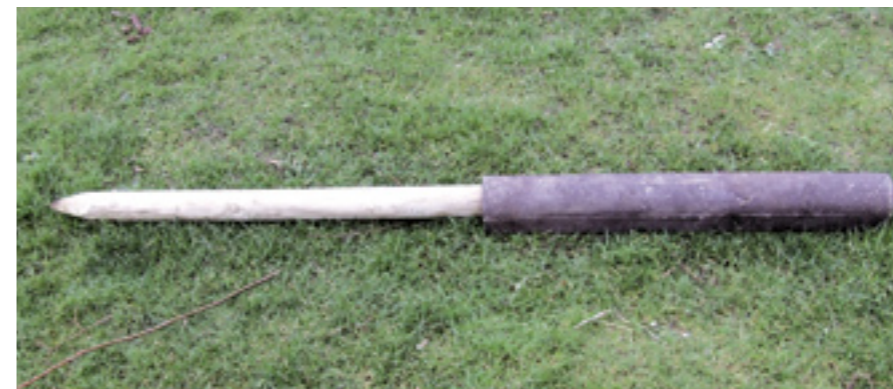
Een nieuw product van Gampet is een houten paal met een kunststof bovenkant. Zit het houten deel steeds onder water dan is het vanzelf geconserveerd. De combinatiepaal is goedkoper dan volledig kunststof en combineert de beste eigenschappen van beide materialen.
