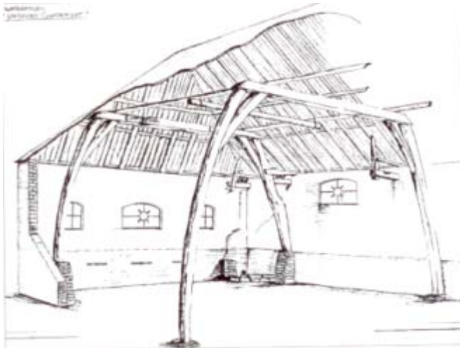
Figuur 13: De bouwtekeningen uit die tijd tonen een bijzondere constructie van houten steunbalken ('gebinten') die vanaf de onderkant van de muur naar binnen bogen.
