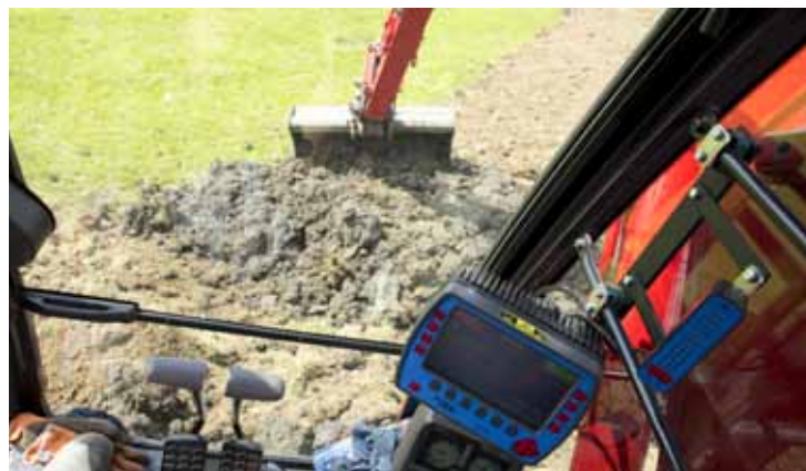
Vanuit de cabine kan de machinist over het scherm heen de bak volgen. Voor het precisiewerk is er de bak.
