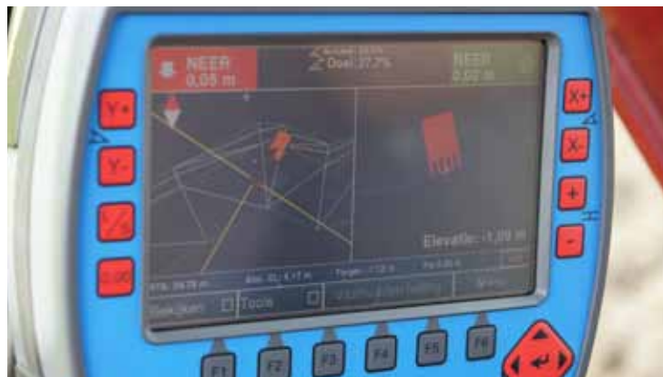
Links en rechtsboven in het scherm wordt aangegeven wat de positie is van de bakhoeft ten opzichte van het gewenste profiel.
