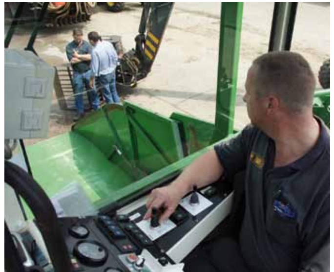
Vanuit de cabine heeft de machinist goed zicht op het vullen van de molen en de afvoervijzel. De cabine heeft airco en is stil.
