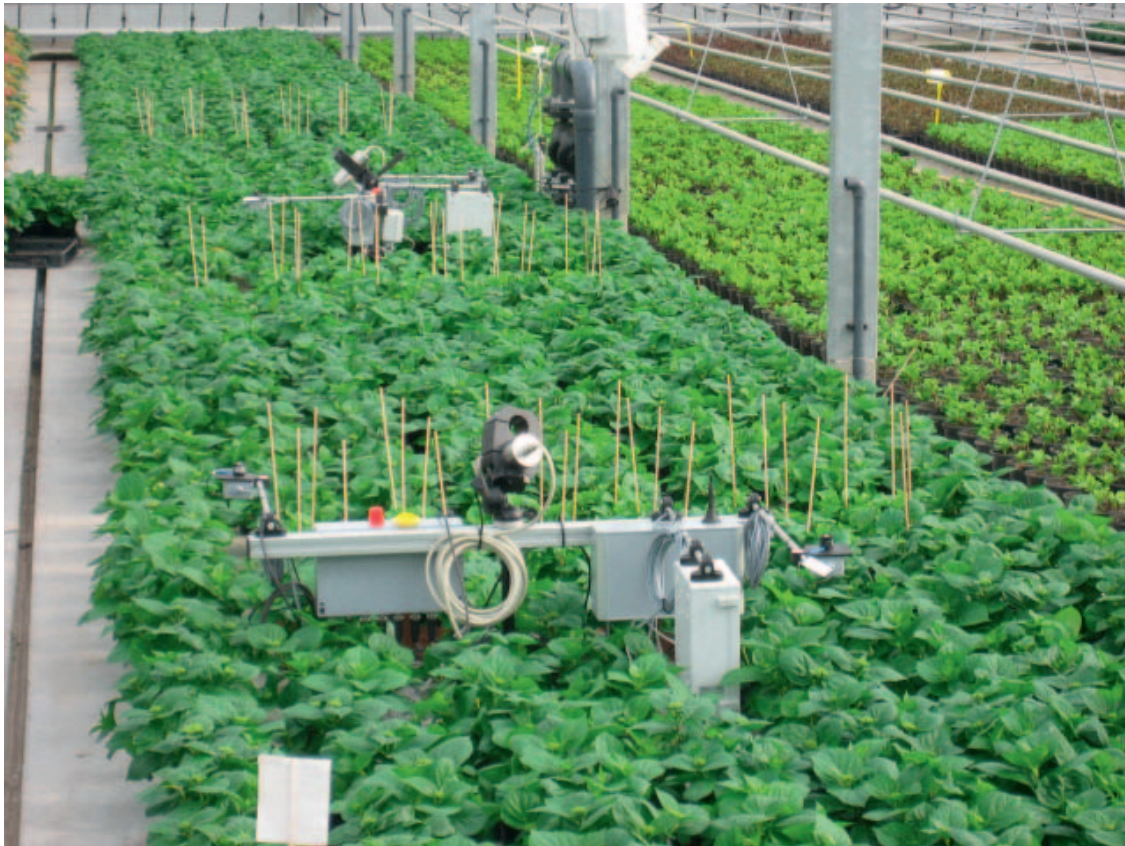
Figuur 2.14. Overzicht van de meetveldjes met daarbij geplaatst de I4all mobiele meetsets. De te volgen partijen werden zorgvuldig in het juiste plantverband gehouden en omringd door randplanten van een vergelijkbare partij (zelfde ras en plantdatum).
