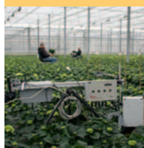
De onderzoekers meten onder andere de RV, temperatuur, CO 2 , PAR-licht, bladtemperatuur, blad dikte, watergehalte en EC.
