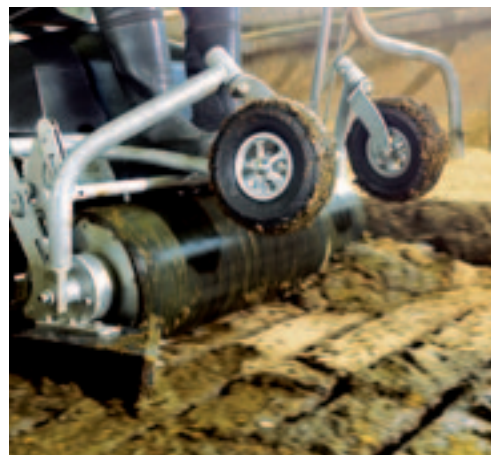
Als je scherp wilt draaien, moet je de zwenkwielen aan de grond zetten. De wals komt dan van de grond.
