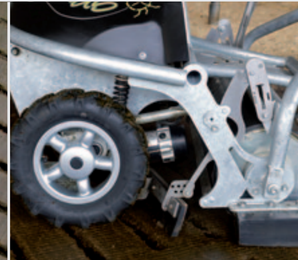
Achter de wals zit een schuifje om de laatste mest te verwijderen.
