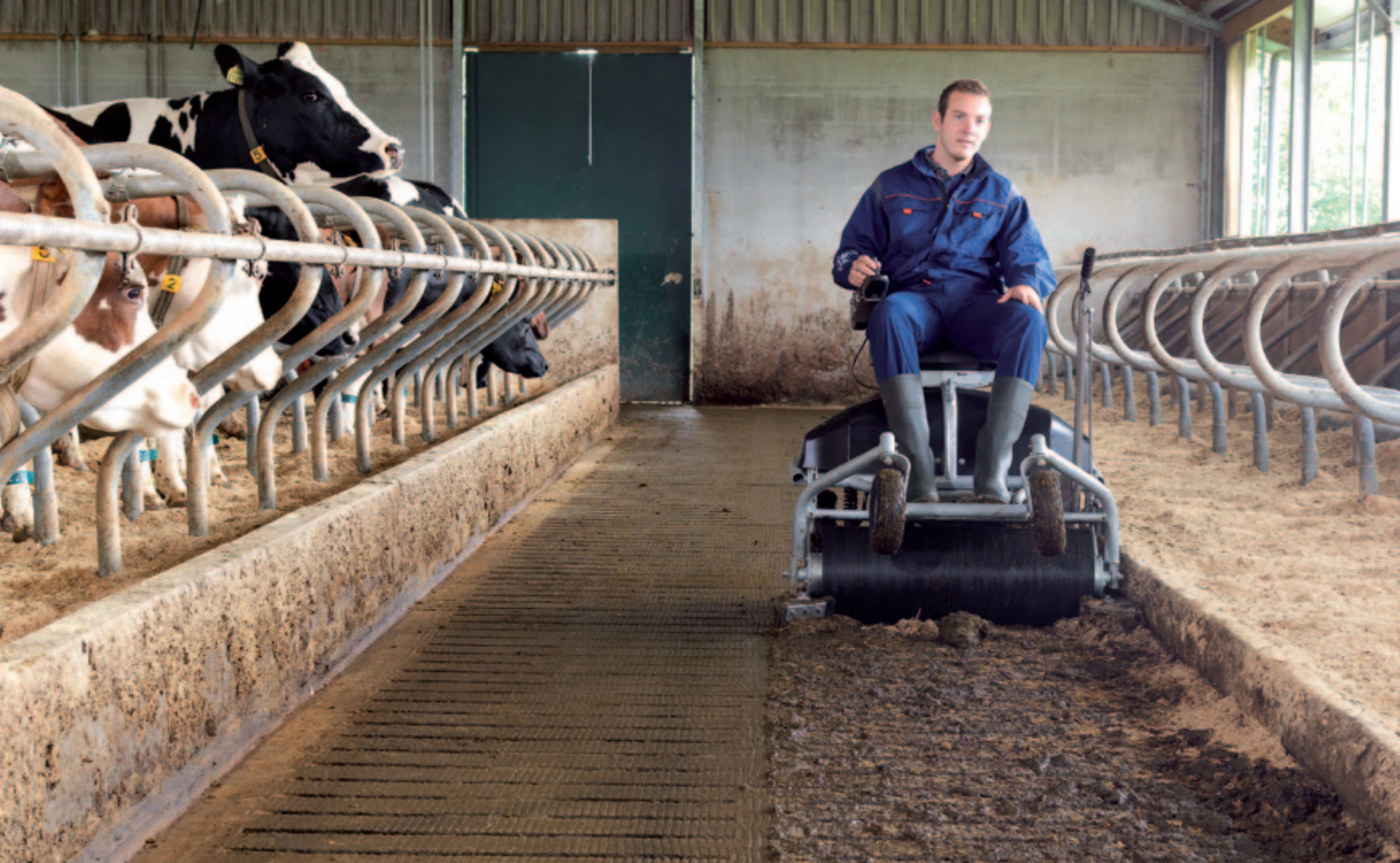
Met de joystick is de gehele roosterwals te bedienen en te besturen.
