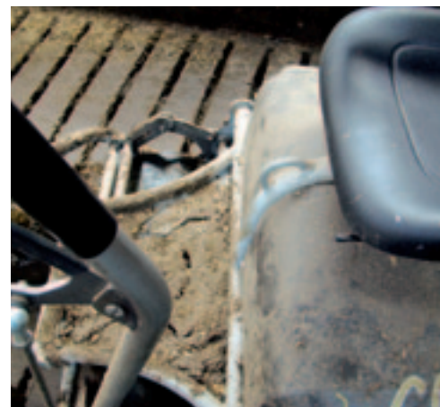
Door de machine aan deze haak op te tillen, is onderhoud eenvoudig uit te voeren.
