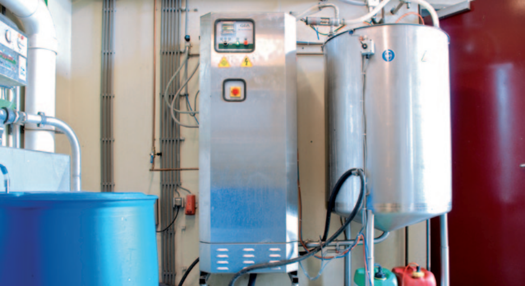
De UV Pure van GEA pasteuriseert niet, maar pureeert. Dat doet het apparaat met UV-licht. Het energieverbruik zou volgens GEA vijf keer lager zijn dan bij pasteuriseren.
