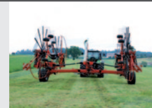
... worden eerst de vier rotoren aan beide kanten van de beide framebalken opgevouwen ...
