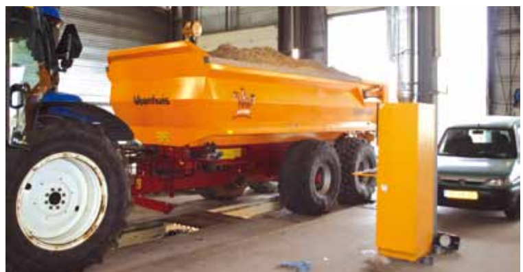
De remmentestbank van Reko Raalte kon een beladen kipper wel aan en kwam het dichtst bij de door Wabco gecalculeerde remvertraging..
