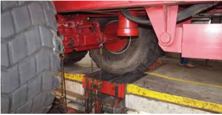
Met kettingen de kipper strak op de rollenbank trekken bij Scania Beers in Deventer gaf al meer remdruk voordat de banden slipten.
