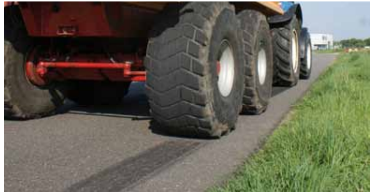
Met de nodige zwarte strepen op het asfalt bij 25 ton op het tandemstel als bewijs van brute remkracht rolde er voor de kipper nog geen 5 m/s 2 remvertraging uit.
