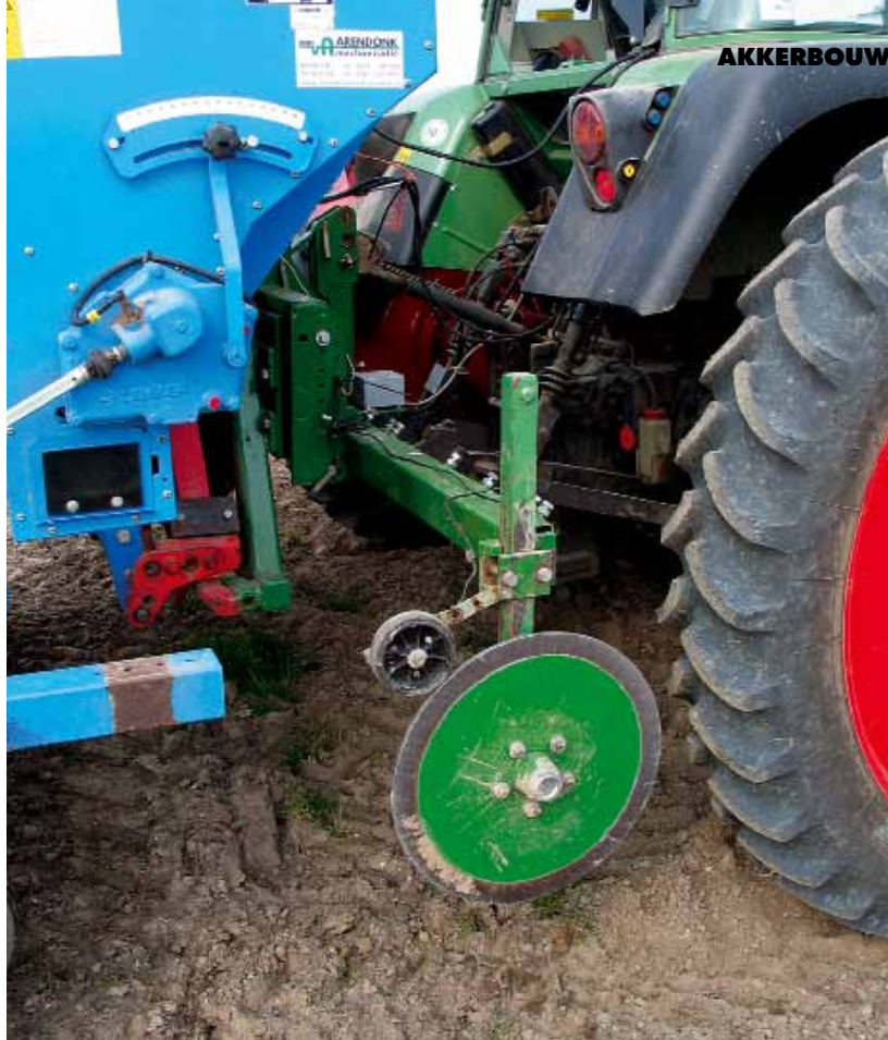
Gestuurde sideshift gemonteerd aan zaaimachine
