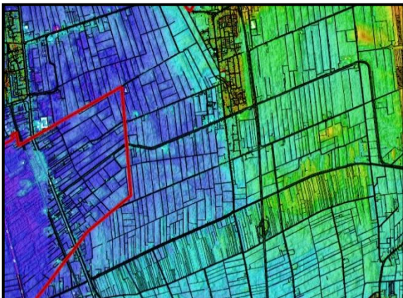
Figuur 7. AHN-kaart van het plangebied. De hoogte neemt toe in de volgorde van blauw-lichtblauw- groen-geel- bruin. De rode lijn is de gemeentegrens van Twenterand.
