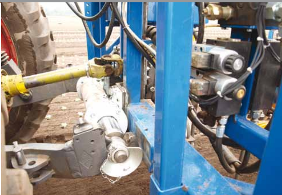
De stabilisator houdt de machine recht in de rij.
