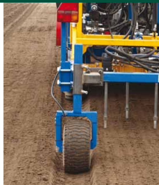
Draaiende aluminium kokers ponsen plantgaten in de geëgaliseerde en aangedrukte grond.
