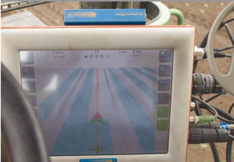
Via de monitor in de trekker is te zien waar de trekker zich op het veld bevindt.
