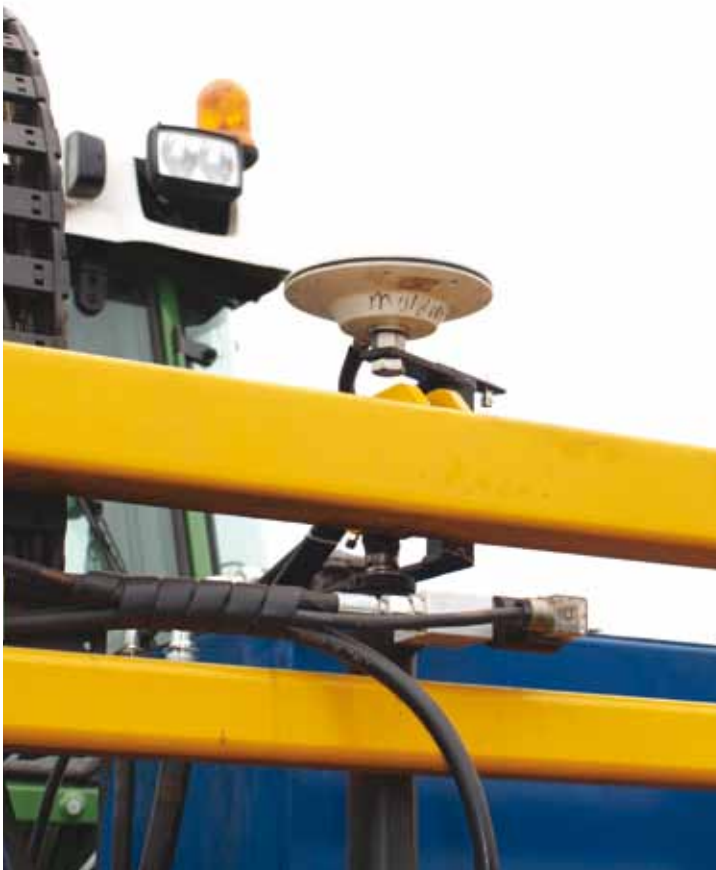
Op de trekker en op de machine (afbeelding links) is een GPS-antenne gemonteerd.
