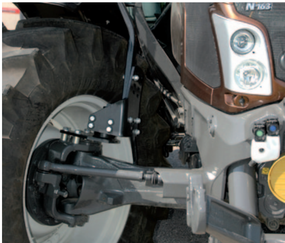
▲ De voorwielen hebben een maximale stuurhoek van 52 graden. Ze kunnen deze grote hoek maken, doordat er bij de motor een wespentaille gecreëerd is. Voorasvering en fronthef zijn opties.
