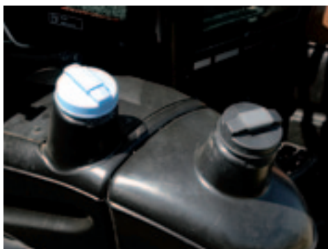
▲ De inhoud van de dieseltank is 230 liter; die van de Adbluetank 27 liter.
