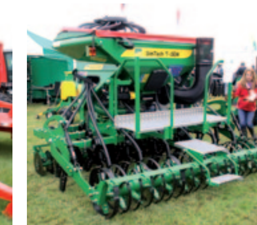
▲ De Nieuw-Zeelandse fabrikant Aitchinson specialiseert zich in directzaaimachines. Zijn nieuwste model zaaimachine heeft een zaadtank van Sulky. De machine is leverbaar in werkbreedtes van 3, 4,8 of 6 meter. De tankinhoud van de gedragen 3 meter brede machine bedraagt 1.000 liter. De inhoud van de tanks van de twee opklapbare machines is 1.700 liter. De Simtech T-Sem heeft drie rijen met zestien veertanden met een T-vormig zaaihouder. Een machine van 3 meter kost 24.450 pond. >
