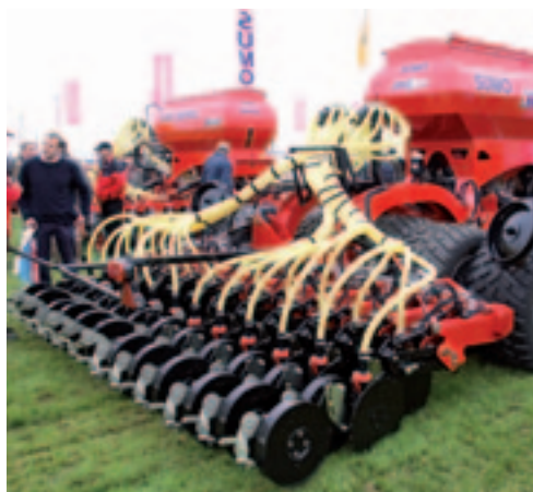
▲ De Versaplus-directzaaimachine van fabrikant Sumo is een doorontwikkeling van de Versadrill. De machine moet meer grondsoorten en moeilijke omstandigheden aan kunnen. Hiervoor heeft de cultivator-zaaimachine extra schijven voor de woelpoten gekregen. Ook het vlakbord is vervangen door een rij dubbele gekartelde schijven. De machine loopt op zes 600/50R22.5 banden. Het zaaisysteem bleef ongewijzigd. Wel is het mogelijk om sommige kouters nu hydraulisch op te lichten.
