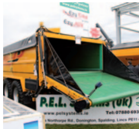
▲ Fabrikant P.E.L. Systems uit Ierland liet deze Ezy Crop zelflossende wagen zien. Hij heeft zowel een hydraulisch aangedreven rollbodem als rolzijkwanden. Via een klep los je de wagen in een stortbak. De optische sensor achterop is standaard. Het M12000-model dat op de show te zien was, heeft een laadcapaciteit van 12 ton, maar grotere wagens zijn leverbaar. Een geveerde dissel en luchtberemming zijn standaard, een afdekzeil en camera optioneel. De 12-tons versie kost 31.000 pond.
