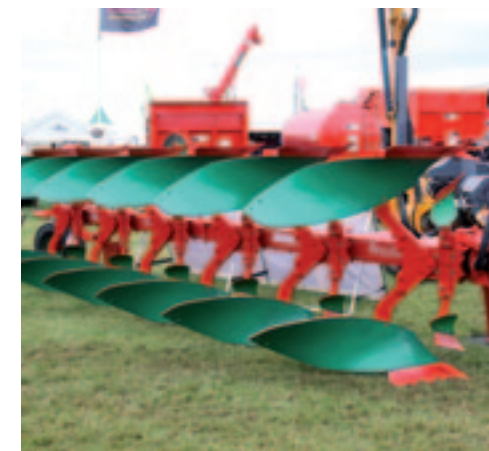
▲ Importeur Reco liet op Cereals deze Spaanse Ovlac-ploeg zien. Ondanks zijn kleur en het model heeft de fabrikant geen connecties met Kverneland. Reco begint met de import van gedragen vier-, vijf- en zesschaarmodellen. Je kunt kiezen uit een breekboutbeveiliging of een beveiliging met veren. Optioneel is een hydraulisch verstelbare eerste schaar leverbaar. Een gedragen achtschaarmodel volgt later.
