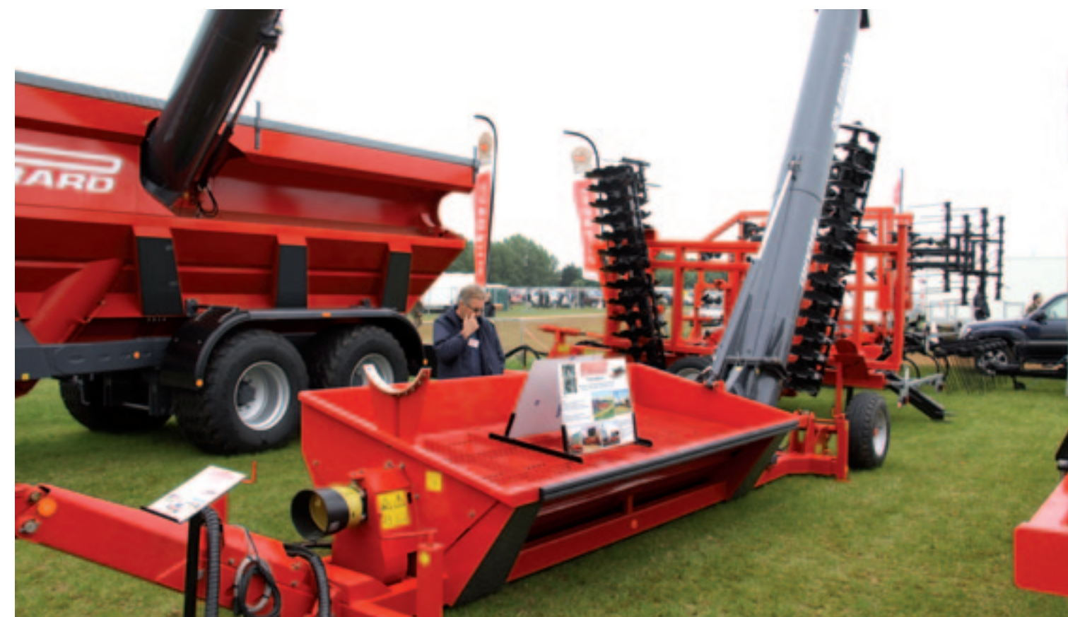
▲ Voor wie vanuit het land vrachtwagens of kiepers met graan wil vullen, maar nog geen overlaadwagen wil aanschaffen, heeft de Franse fabrikant Perard een oplossing: de Trans-Express 500. Dit 'overlaadstation' kan volgens de fabrikant in 4 tot 5 minuten 12 ton graan overladen. Zo kun je een normale kieper blijven gebruiken, die ook de rest van het jaar inzetbaar is. De Trans-Express kun je met een trekker of 4x4 vervoeren. Je hebt wel een trekker nodig voor de aftakasandrijving.
