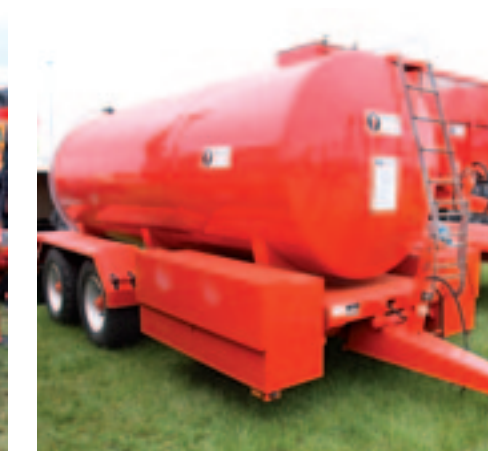
▲ Om meer capaciteit uit de veldspuit te halen, kiezen sommige bedrijven voor een watertank die met de spuit meerdert. Zeker in Engeland, waar altijd thuis moet worden getankt, bespaart dit veel tijd. Dit 13.000 liter-model van de Engelse fabrikant Triffit heeft een rvs-tank en twee afsluitbare bakken om spuitmiddelen in mee te nemen. Met een losse pomp achterop, aangedreven door een benzinemotor, is de spuit in een mum van tijd te vullen. Tanks van 4.000 tot 18.000 liter zijn leverbaar.
