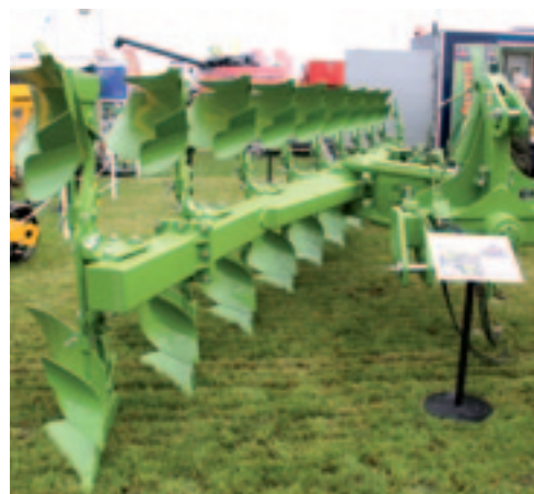
▲ Op de grotere Engelse bedrijven zijn rups- en kniktrekkers inmiddels gemeengoed. Maar de machines die hierbij horen vaak niet. Met de 170 Series MA negenschaar gedragen ploeg pusht fabrikant Dowdeswell het concept nog iets verder. De 1+7+1 wentelploeg heeft standaard een hydraulische werkbreedteverstelling. De puntafstand bedraagt 91 cm en de afstand van punt tot onderkant frame 74 cm. Tijdens transport loopt de ploeg op een wiel dat ook als dieptewiel fungeert.
