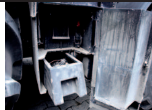
▲ Claas wint ruimte onder de cabine met het verplaatsen van de luchtdruktank. Die ruimte besteedt de fabrikant handig.
