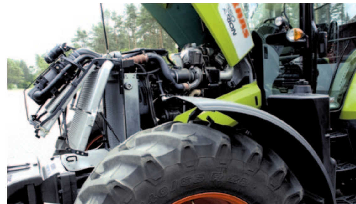
▲ Het koelpakket is 25 procent groter. Dat is nodig om het gerecirculeerde uitlaatgas te koelen. Wanneer het uitlaatgas gekoeld de verbrandingskamer ingaat, is het proces volgens Claas efficiënter.
