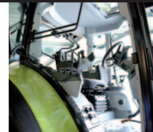
▲ Doe je het rechterportier open, dan zie je de hele zijruit van je vandaan klappen. De vijfde stijl zorgt voor een korter portier links.
