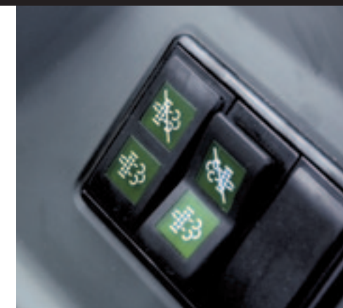
▲ Het zogenaamde regenereren om het DPF te reinigen kan in de cabine met een druk op de knop uitgesteld worden.
