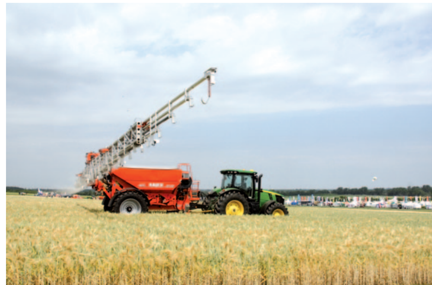
▲ De grote getrokken Rauch heeft een 36 meter boom verdeeld in zes delen met elk een groot aantal punten. Op elk boomdeel zit een sensor voor de chlorofylmeting. Daarmee krijgt de procescomputer veel meer info over het gewas en kun je nauwkeuriger sturen. Door de hoge aanschafprijs (ongeveer 150.000 euro) is dit echt een machine voor heel grote akkerbouwbedrijven.
