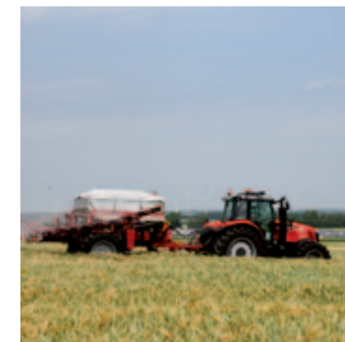
▲ De Kongskilde Windshield heeft een pneumatisch verdeelsysteem en een voorraadbak van 9.000 kg. De kunstmest wordt met lucht over in totaal twintig verdeelpunten (ketsplaten) verdeeld. Aangepassing op de groenheid van het gewas wordt met een tweevoudige sensor gedaan. De boom vouwt zich verticaal op.
