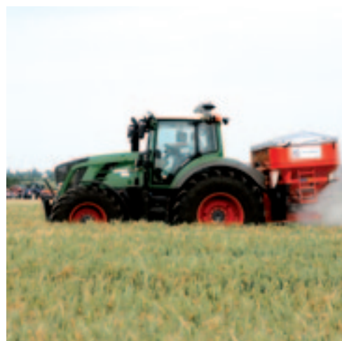
▲ Kuhn/Rauch liet ook zijn meest geavanceerde aanbouwstrooier zien. Met hydraulisch aangedreven strooischijven en een meervoudig verstelbare uitstroomopening kan de procescomputer de instelling zo aanpassen dat elke vierkante meter evenveel kunstmest krijgt. Hier is de trekercabine voorzien van de Yara N-sensor.
