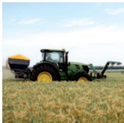
▲ Bogballe met de Greenseeker-gewassensor. De sensor bepaalt hoeveel stikstof het gewas nodig heeft. Bij normaal strooien draaien bij deze machine de strooischijven van buiten naar binnen. Bij het strooien van geren verandert de draairichting van de schijven. De maximumstrooiafstand wordt kleiner, maar de strooibreedte blijft ongewijzigd.
