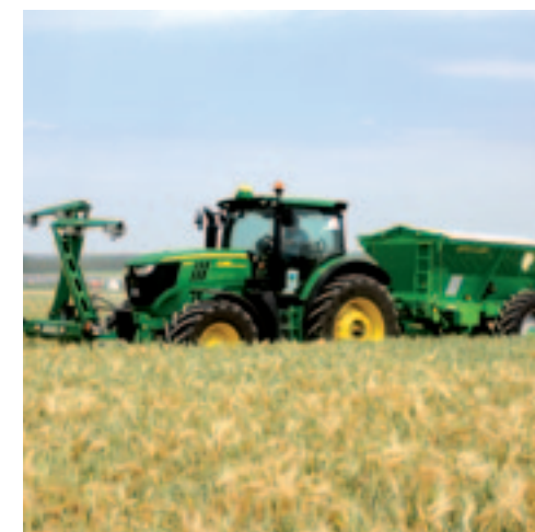
▲ De Gustrow GWK 6000 heeft een voorraadbak voor 6.000 kg. De hydraulische aandrijving wordt elektronisch aangestuurd. In de voorraadbak zorgt een ketting voor de aanvoer van de kunstmest. De strooier is ook voor andere organische meststoffen bruikbaar.
