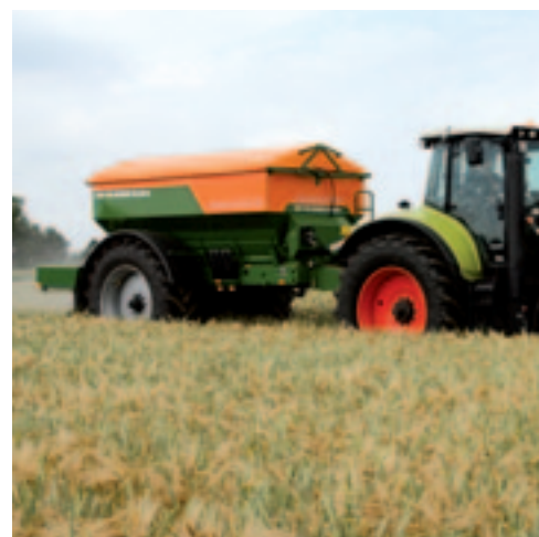
▲ De getrokken Amazone heeft in navolging van Kuhn/Rauch nu ook hydraulisch aangedreven schijven, zodat onafhankelijk van het motor-toerental de draaisnelheid van de strooischijf kan worden aangepast aan de gewenste strooibreedte.
