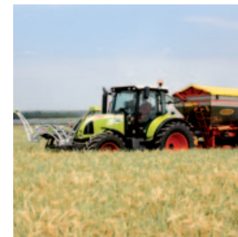
▲ De trekker voor de getrokken Bredal-strooier is voorzien van de Fritzmeier Isaria cropsensor in Claas-kleuren. De voorraadbak van de strooier heeft een hydraulisch aangedreven bodemband. In de mechanische aandrijving van de linkerschijf zit een hydraulisch schakelbare enkelvoudige tandwielreductie. Aangepassing voor geren strooien heeft deze machine niet. Opvallend zijn de 46 inch velgen.
