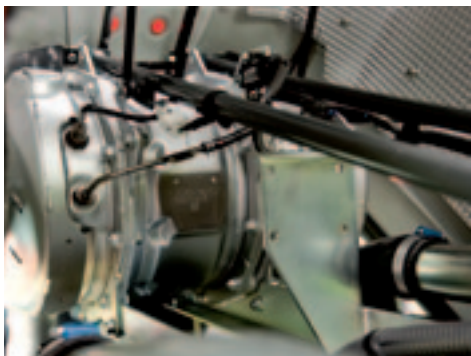
▲ Het dieselpartikelfilter onder de motorkap. Met een druk op de knop reinig je het filter.
