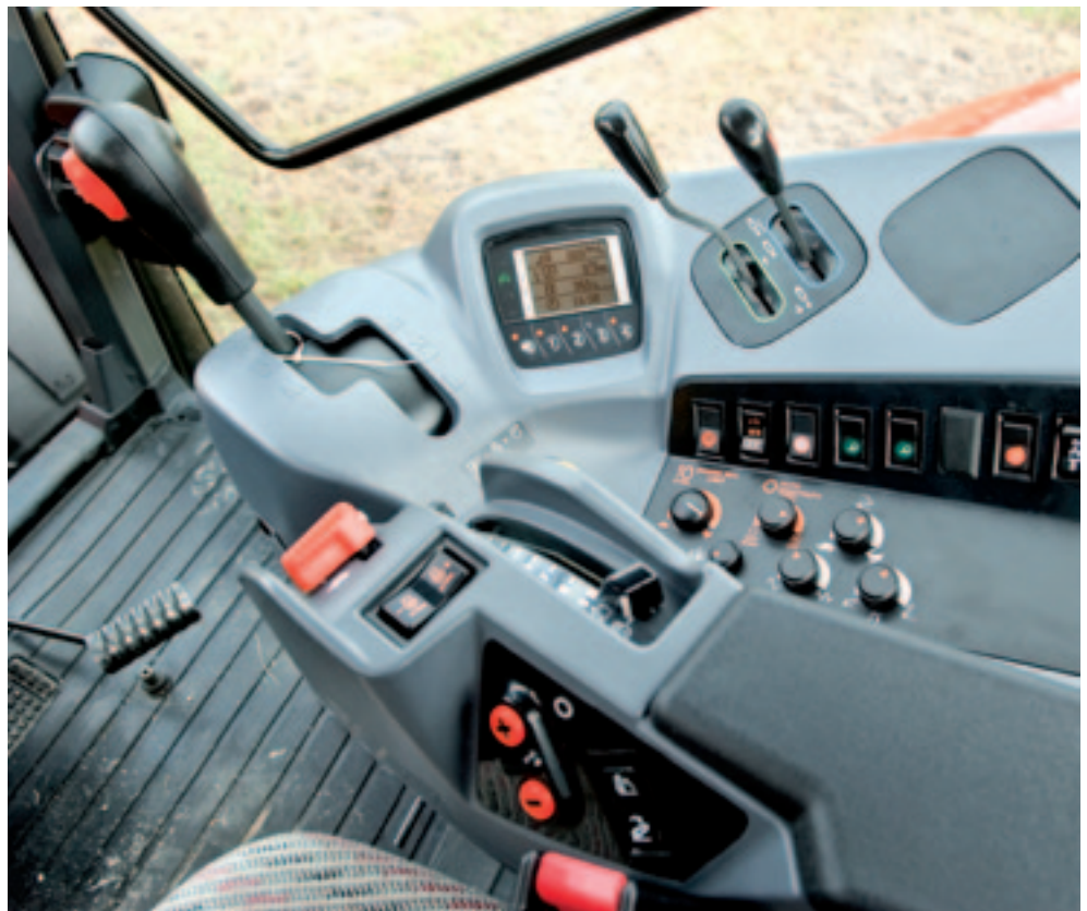
▲ Het rechterconsole herbergt de versnellingspook, de boordcomputer en de bediening van de hydraulische ventielen en hef. Op de armleuning het handgas, de bediening van de hef en powershiftknopjes.
