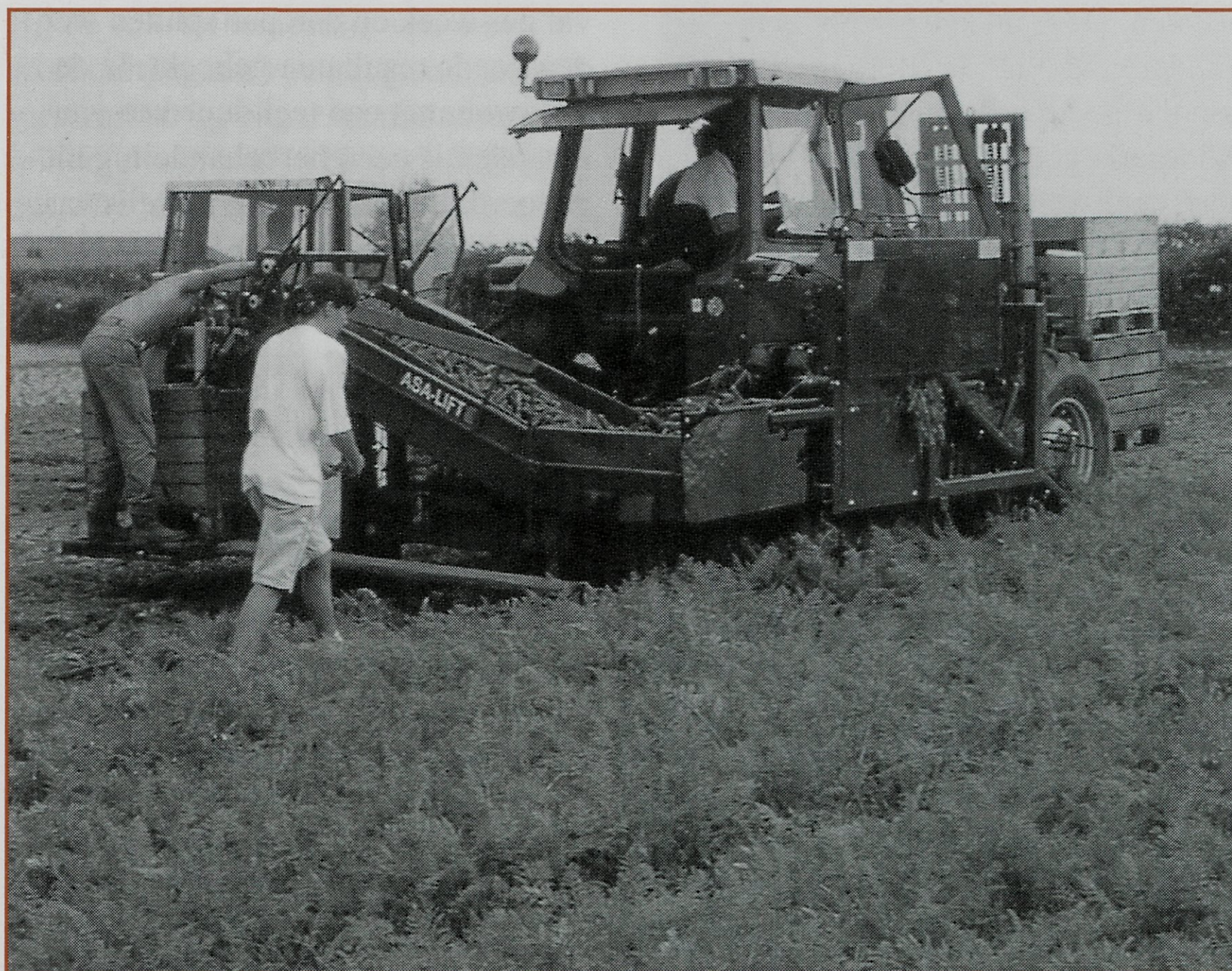
■ Oogst van de BC-peen. Voldoende loofstevigheid is noodzakelijk om met de klemband-rooier te werken.
