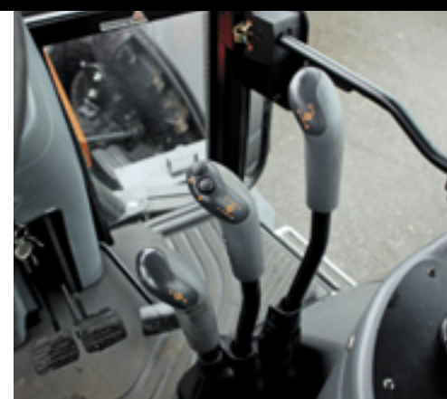
▲ De 36 versnellingen zijn verdeeld over drie groepen. De vooruit/achteruit is gesynchroniseerd.
