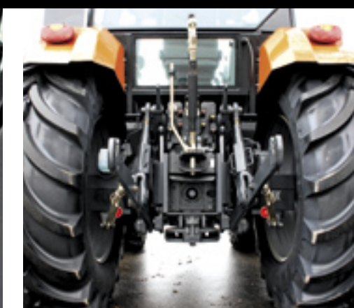
▲ De stabilisators, snelkoppelingen en verstelling van de heflatten zijn van Walterscheid.
