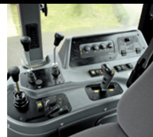
▲ De rechterconsole is overzichtelijk. Met de kruishendel bedien je twee ventielen.
