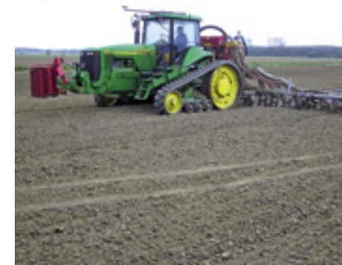
Met rtk-gps is het rijpadensysteem goed uitvoerbaar, zoals hier met sleepslangen vanaf rijpaden.
