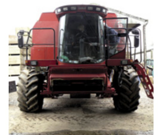
Permanente rijpaden bij Manfield in Yorkshire (UK) gecombineerd met directzaai. De trekker heeft een spoorbreedte van 1,9 meter en de maaidorser 3,8 meter. Het kost slechts 4 liter diesel per hectare om opnieuw in te zaaien.
