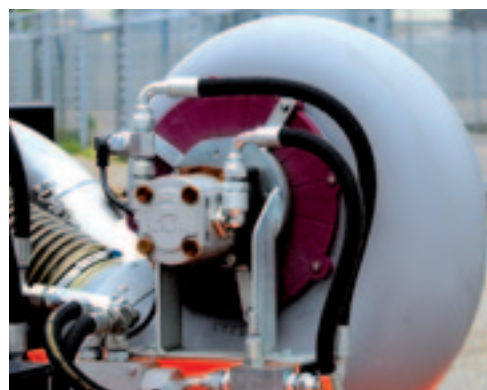
De ventilator wordt hydraulisch aangedreven.
