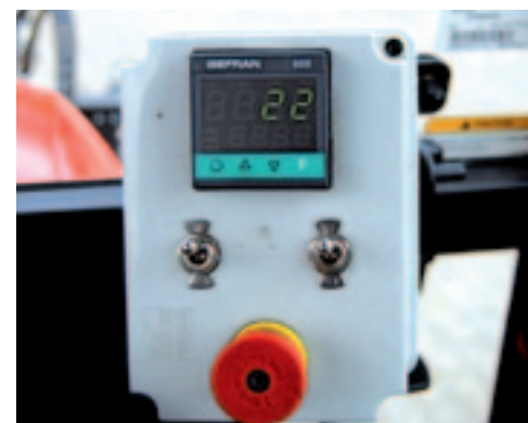
De bediening bestaat uit niet meer dan een dodemansknop en twee schakelaars.
